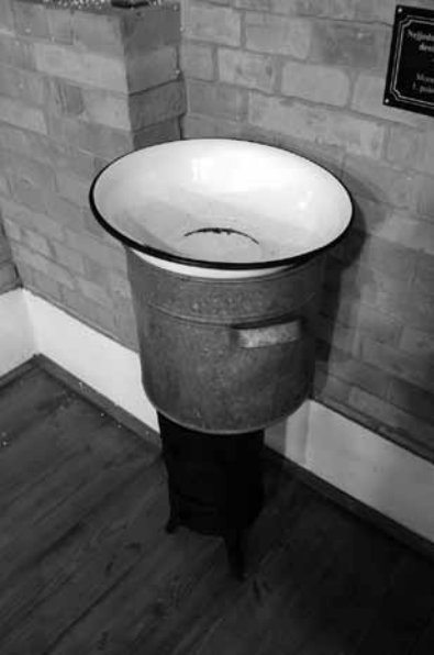
Nejjednodušší typ domácího destilačního zařízení – lavorovica, Moravské Kopanice, 1. polovina 20. století.
