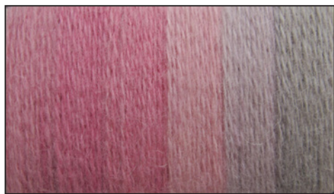
Standardní vybarvení vlněné příze kyselinou karmínovou z košenily. Odstíny zleva: vlna nemořená, mořená kamencem, mořená kamencem a chloridem cínatým, mořená kamencem a modrou skalicí, mořená kamencem a zelenou skalicí. Foto A. Samohýlová.
