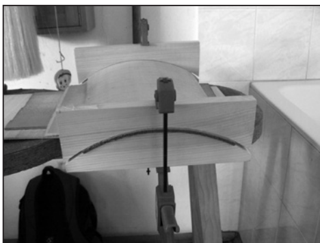
Obr. 5. Způsob ohýbání desky na skřípky. Foto J. Höhn. Archiv NÚLK.
