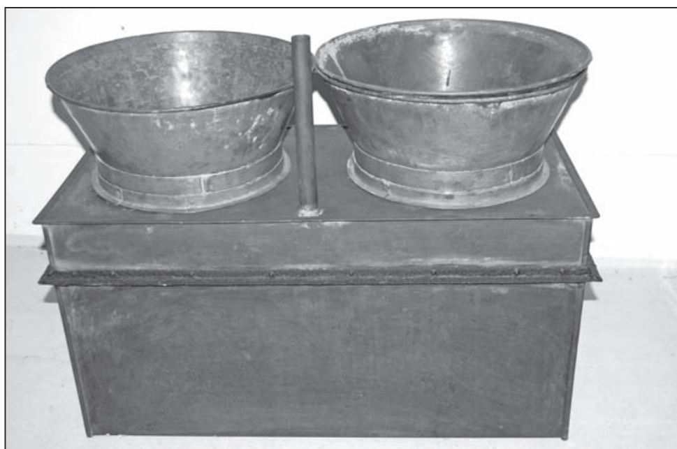
Duplikátor, nádoba na rozpouštění vosku ve vodní lázni.
