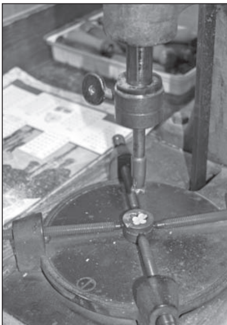
Lisovací stroj na presování drobných kvítků.
