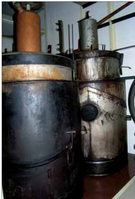
2. Výklopné kotle k pálení slivovice zabavené celním úřadem v r. 2005, E 33.566, E 33.567, sbírka Slovákého muzea v Uherském Hradišti. Foto: M. Kondrová.
