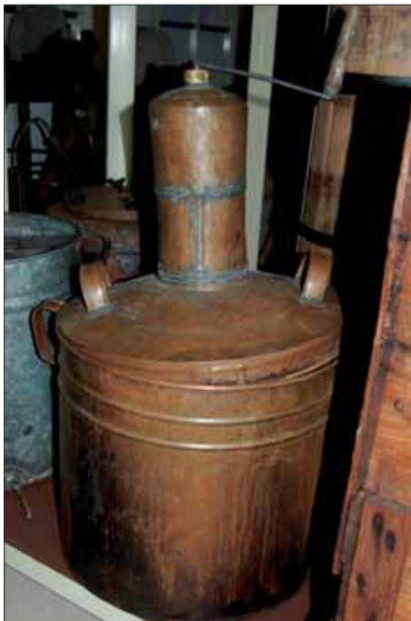
1. Malý kotel s víkem a mícháním k domácímu pálení slivovice, E 33.378, sbírka Slovákého muzea v Uherském Hradišti. Foto: M. Kondrová.
