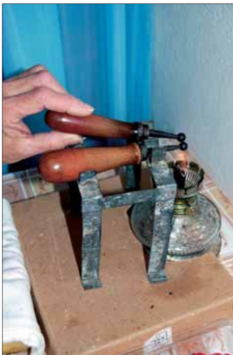
Kuflírování – nahřívání železek nad lihovým kahanem.
